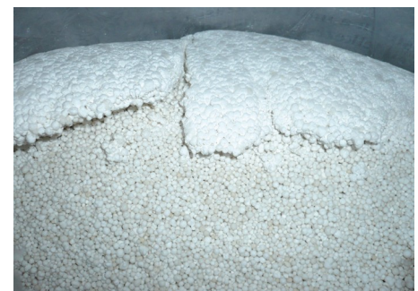
Ciclos térmicos que dan como resultado la desintegración del producto en la capa superior del producto almacén
