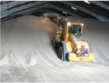
Conducción INACEPTABLE dentro de la pila
