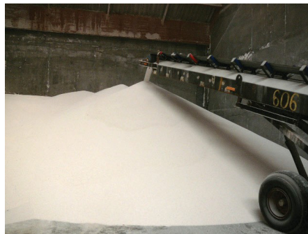
Buena práctica: mover la barra volteadora a fin de evitar la segregación.
