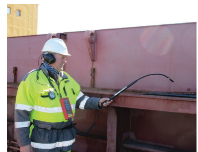
Probando si hay fugas por medio de ULD (Detector de Fugas por Ultrasonido)
